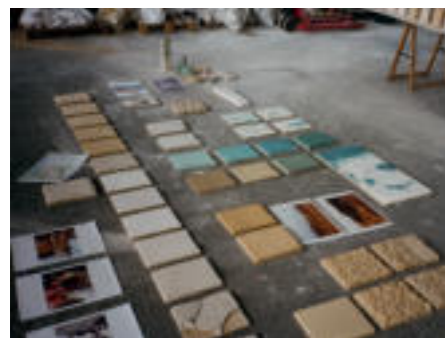
Algengefärbte und akustische Gipsprototypen. Algae-coloured and acoustic plaster prototypes.
